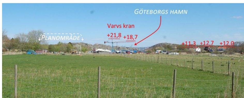
Figur 30 Kranen vid Brännö varv har en nockhöjd som motsvarar +21,8. Observera att plushöjden anger höjd från nollnivå, från så kallad havsnivå, inte själva anläggningens höjd. Marknivå vid kranen är cirka +1,8 så kranen är cirka 20 meter hög. Till höger finns ett gles bebyggelseområde med olika nockhöjder från +11,3 till +12,7. Inom planområdet kommer bebyggelsen att ha olika nockhöjder, den har reglerats olika beroende byggrättens läge och planerad funktion på byggnaden. För jämförelse med planförslaget se även figur 40, 41 och 42 längre fram i dokumentet.
